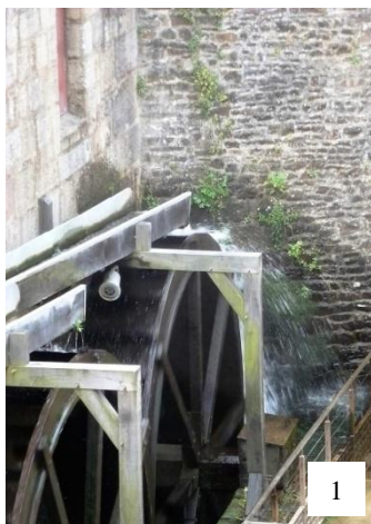
1- Roues des moulins du château 2 Etiers en bois amenant l'eau sur chacune des roues
